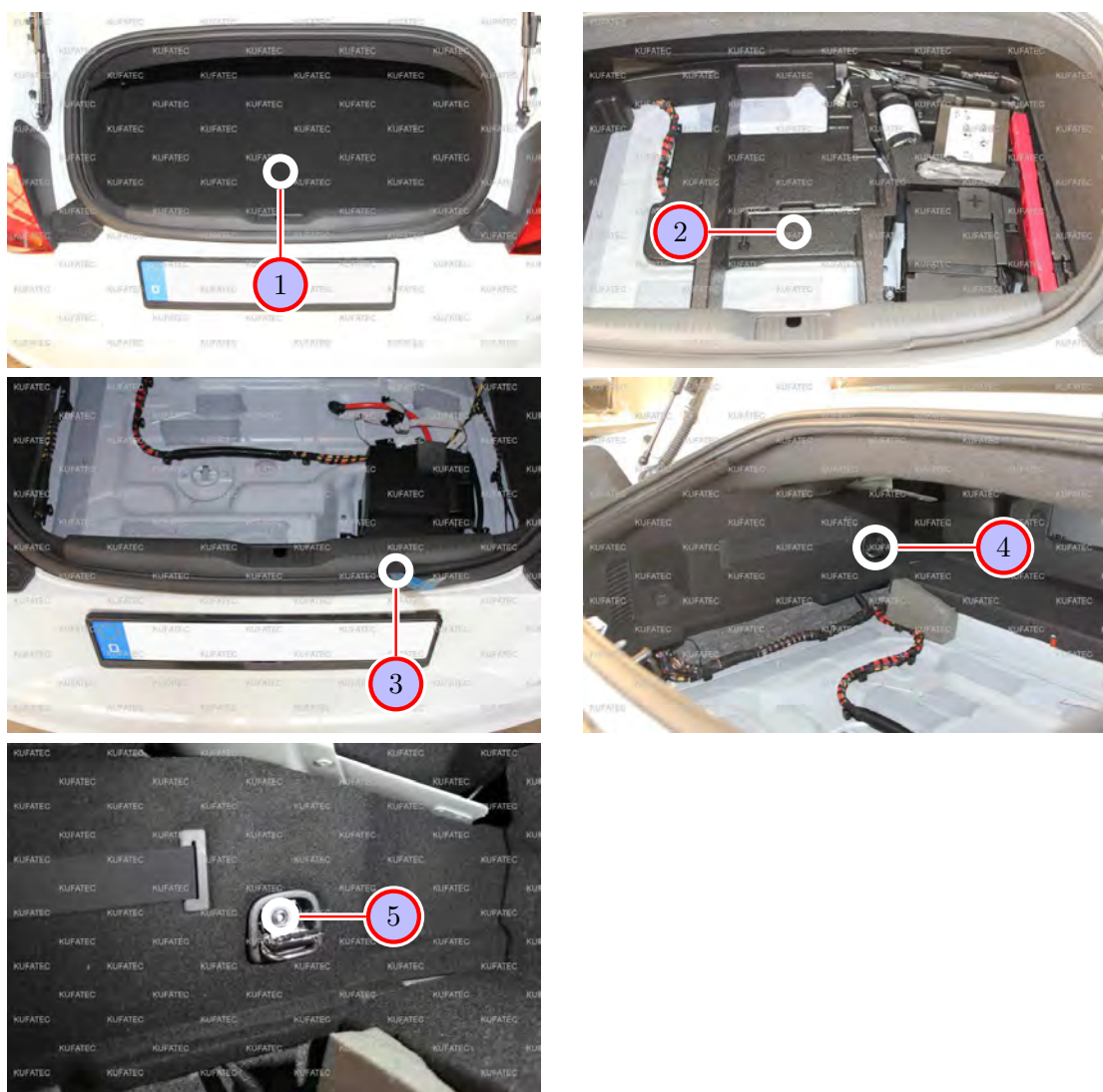
Abbildung 3: Demontage Seitenverkleidung Kofferraum
